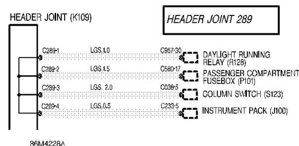
Les collecteurs de raccordement sont identifiés par le numéro du connecteur correspondant avec un suffixe numérique détaillant la broche de sortie du fil ; par exemple C289-1 signifie la broche 1 du connecteur 289. La couleur de l'isolant du fil est identifiée de la façon habituelle. Lorsqu'un fil de couleur dominante est parcouru d'un fil de couleur secondaire, la couleur principale est identifiée en premier ; par exemple LGS = vert clair à filet gris.
