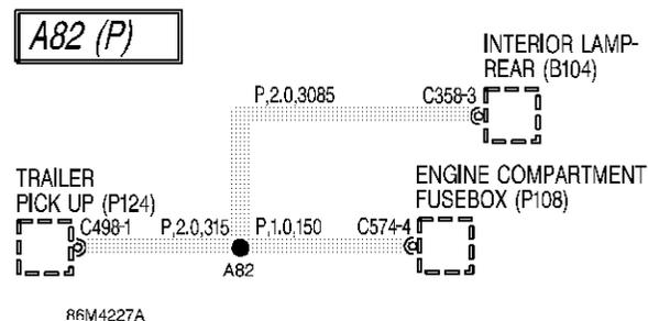
Les détails des boîtes à fusibles sont suivis d'une section couvrant les collecteurs et les épissures, soulignant la façon dont les épissures internes et les collecteurs de raccordement alimentent les faisceaux. Utiliser ces informations au cours du diagnostic des pannes électriques, pour contrôler les symptômes des circuits connexes et localiser plus aisément la zone de recherche.
