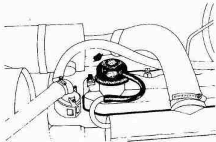
Fig. 69. Tapón de llenado de aceite del motor.
