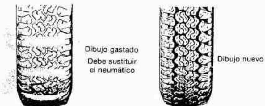
Fig. 87. Banda de rodadura.
